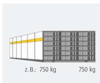
Punktlastverteilung mit Standard-Rollregalsystem.
